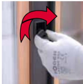
Portare l'anta secondaria in battuta sul telaio e ruotare le maniglie per far fuoriuscire i catenacci e bloccare l'anta secondaria.
